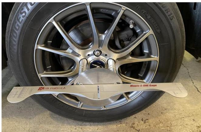
6. 測定する前後の反対側に、サポートLを取付ける。
