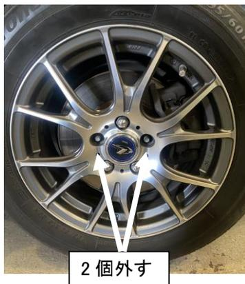
3. 車両側のハブボルトのネジピッチを確認し、サポート S を取付ける。
